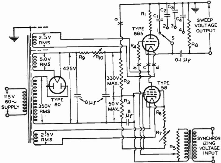
**LINEAR SWEEP-CIRCUIT OSCILLATOR DIAGRAM
