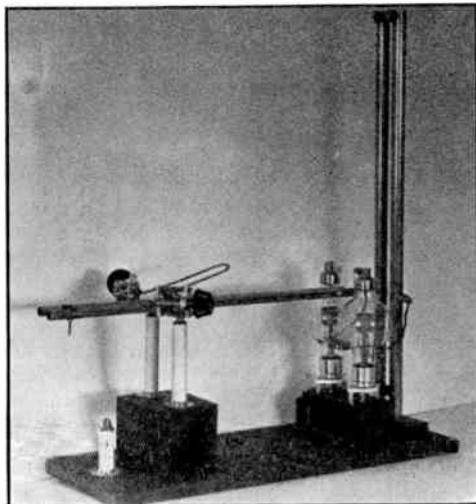
**FIG. 1411— A 112-MC. TRANSMITTER EMPLOYING THE CIRCUIT "C" OF FIG. 1407**
