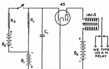
FIG. 1803 — TIME-DELAY CIRCUIT USING A TYPE 45 TUBE
