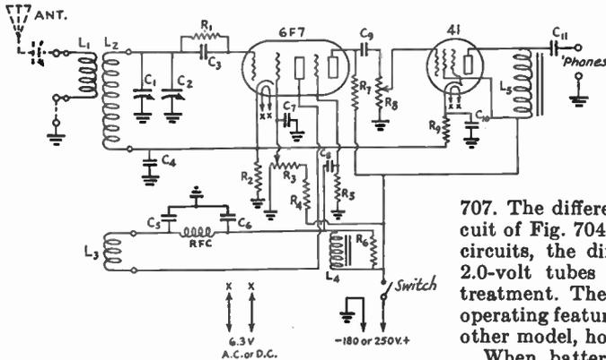
**FIG. 711 — CIRCUIT DIAGRAM OF THE ADVANCED TWO-TUBE RECEIVER**
