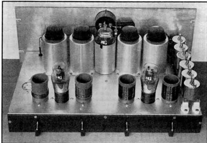
**FIG. 919 — A REAR VIEW OF THE BAND-SWITCHING EXCITER**
