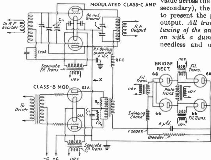
FIG. 1211 — CONTROLLED-CARRIER CIRCUIT FOR 1000-VOLT TUBES (W2HLM)
