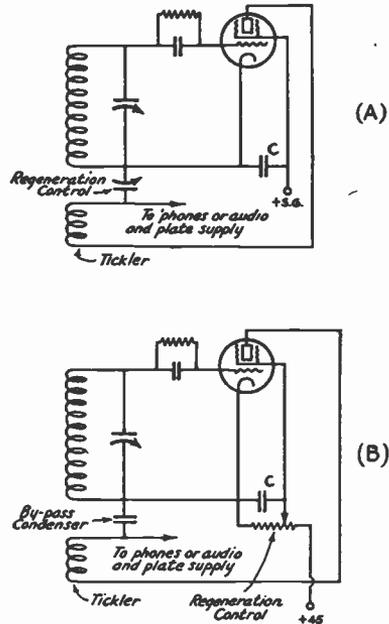
FIG. 603 — METHODS OF CONTROLLING REGENERATION
