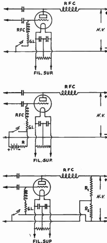
FIG. 1002 — THREE METHODS OF BLOCKED-GRID KEYING
