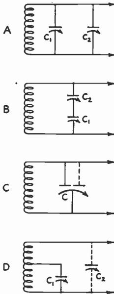
FIG. 602 — ESSENTIALS OF FOUR POPULAR BAND-SPREADING TUNING SYSTEMS
