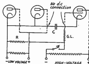
FIG. 1006 — UTILIZING THE LOW VOLTAGE POWER SUPPLY FOR BLOCKING BIAS IN BLOCKED-GRID KEYING
