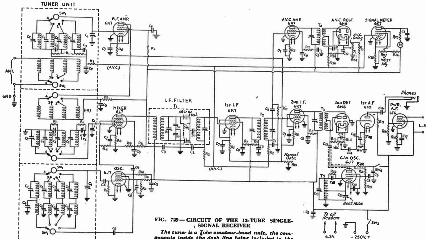
FIG. 729—CIRCUIT OF THE 12-TUBE SINGLE-SIGNAL RECEIVER
