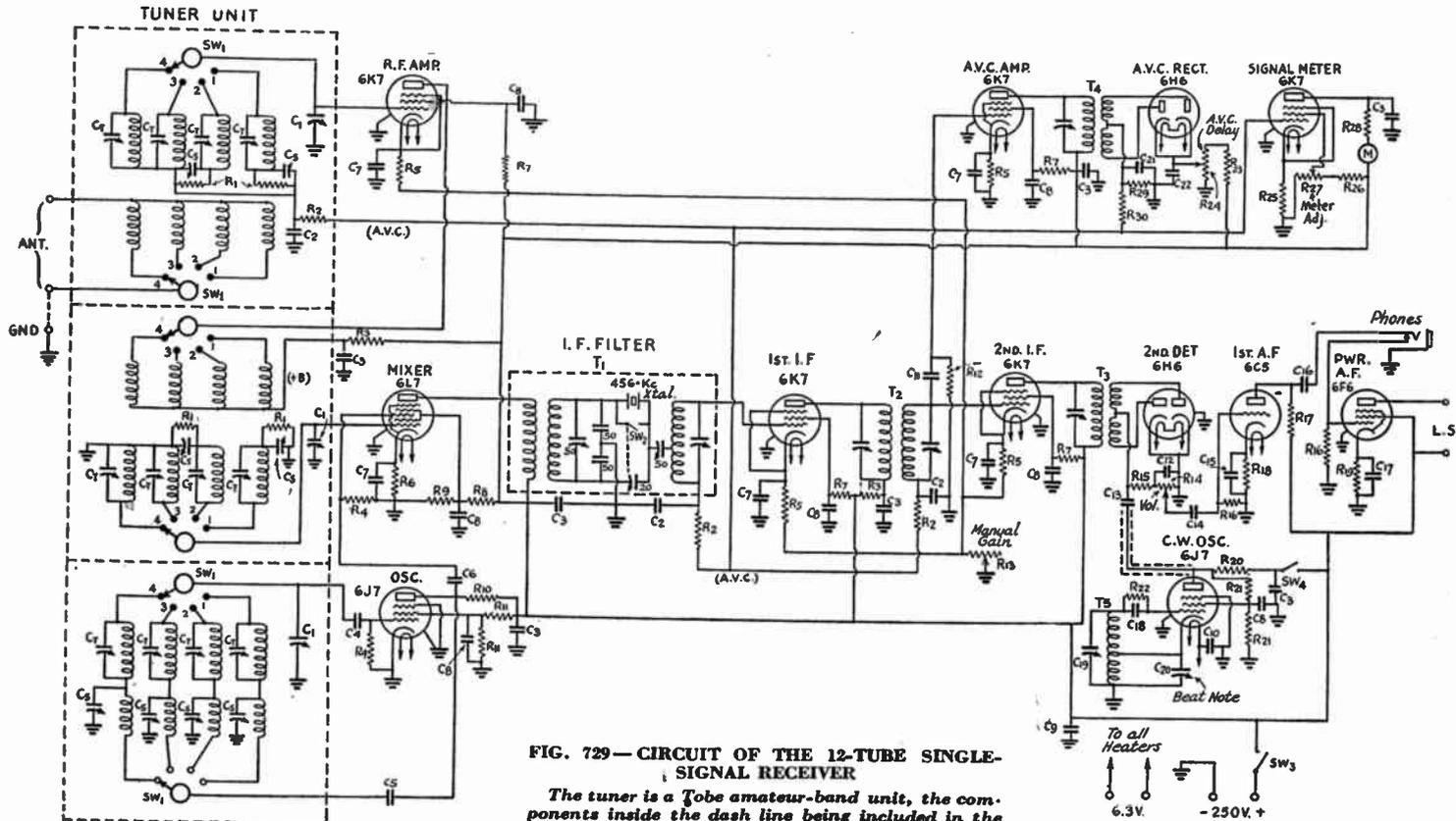
FIG. 729—CIRCUIT OF THE 12-TUBE SINGLE-SIGNAL RECEIVER
