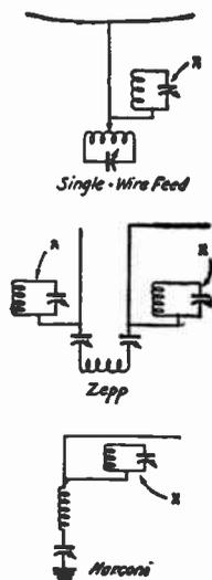
**FIG. 832—TUNED TRAP CIRCUITS TO REDUCE HARMONIC RADIATION**
