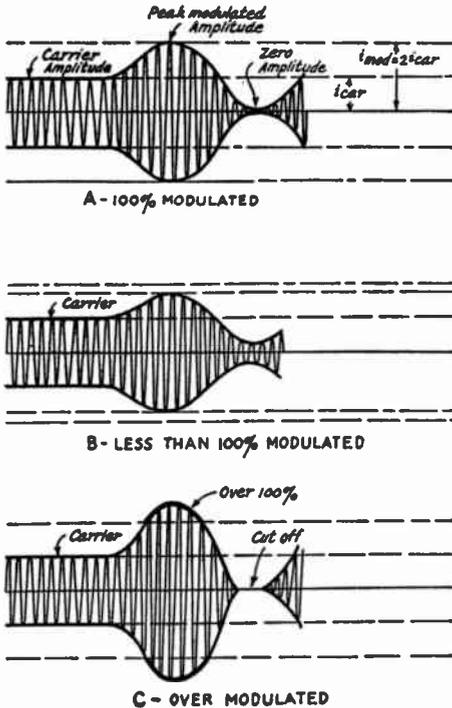
FIG. 1102 — GRAPHICAL REPRESENTATION OF THE AMPLITUDE MODULATED WAVE
