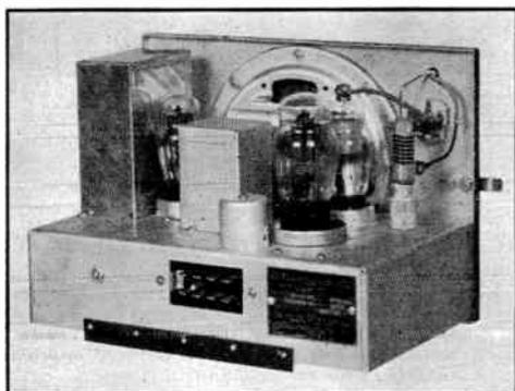
FIG. 1312 — A MOBILE RECEIVER EMPLOYING THE CIRCUIT GIVEN IN FIG. 1311
