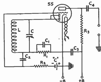
FIG. 1709 — SIMPLE 'PHONE MONITOR USING A TYPE 55 TUBE
