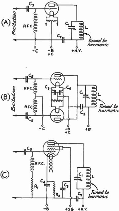
**FIG. 823 — FREQUENCY MULTIPLYING CIRCUITS**
