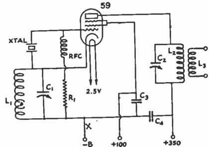
FIG. 909 — CIRCUIT OF THE SINGLE-TUBE CRYSTAL TRANSMITTER
