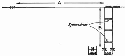
**FIG. 1607 — THE ZEPPELIN ANTENNA**
