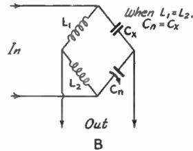
**FIG. 411 — CAPACITANCE AND INDUCTANCE-CAPACITANCE BRIDGE CIRCUITS WIDELY USED FOR NEUTRALIZING IN TRANSMITTERS AND RECEIVERS**
