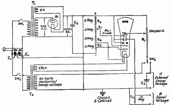
FIG. 1717 — A PRACTICAL OSCILLOSCOPE CIRCUIT
