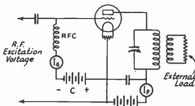
**FIG. 811 — A SIMPLIFIED AMPLIFIER CIRCUIT**
