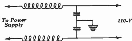
FIG. 1010 — R.F. FILTER FOR THE POWER LINE
