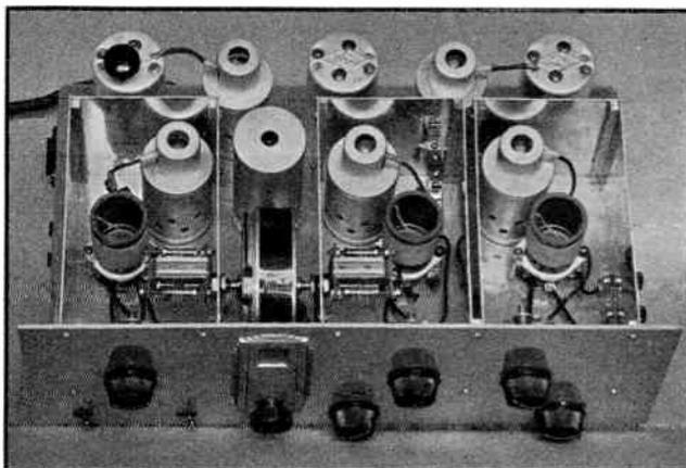
FIG. 721 — A SIX-TUBE REGENERATIVE SINGLE-SIGNAL SUPERHETERODYNE RECEIVER
