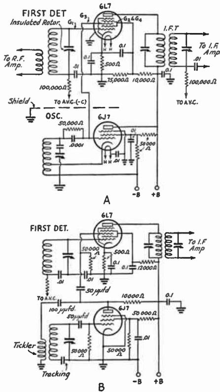
FIG. 612—CONVERTER CIRCUITS FOR THE 6L7 METAL TUBE
