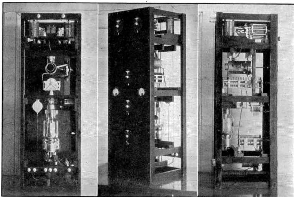
FIG. 929 — THREE VIEWS OF THE HIGH-POWER AMPLIFIER
