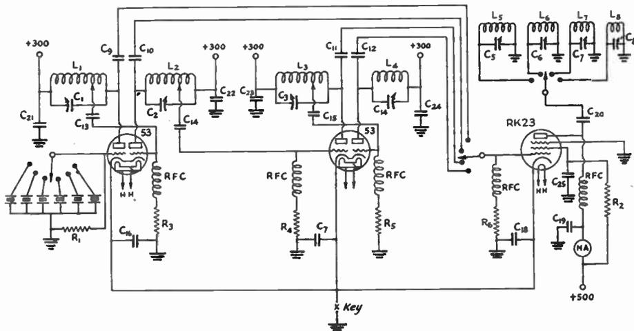
FIG. 920 — CIRCUIT DIAGRAM OF THE BAND-SWITCHING EXCITER
