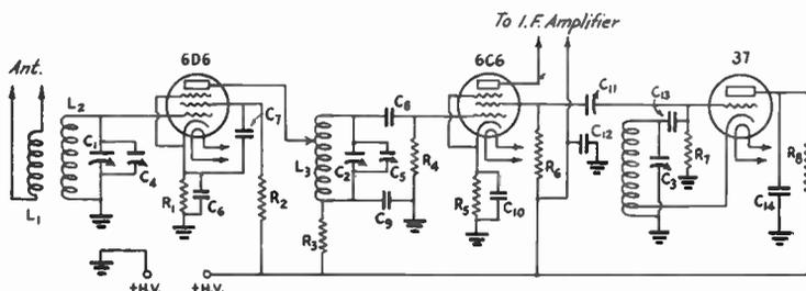
FIG. 1317 — A GLASS-TUBE INPUT CONVERTER SUITABLE FOR THE 56-MC. SUPERHETERODYNE
