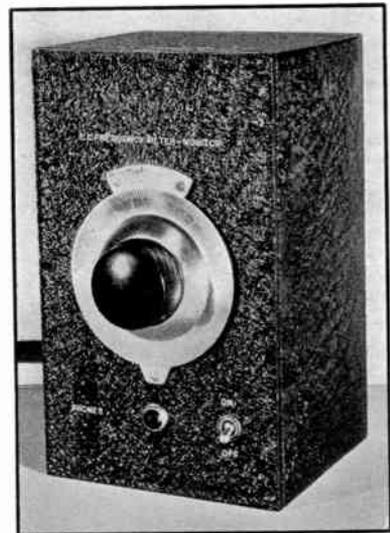
FIG. 1706 — A TWO-TUBE FREQUENCY-METER MONITOR
