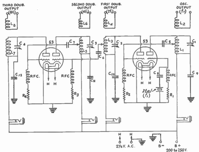
FIG. 917—CIRCUIT DIAGRAM OF THE 53 EXCITER UNIT
