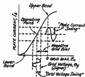
FIG. 502 — OPERATING CHARACTERISTICS OF A
