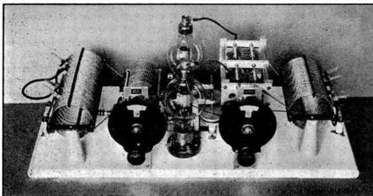
FIG. 923 — A PUSH-PULL AMPLIFIER FOR 50T'S OR 800'S
