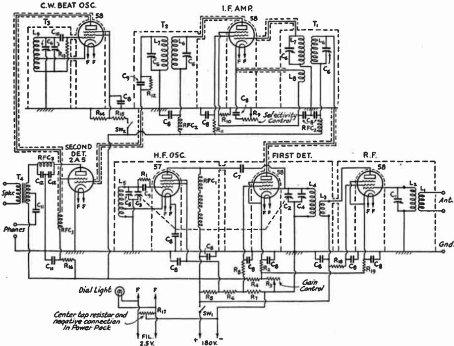
**FIG. 723 — CIRCUIT OF THE SIX-TUBE REGENERATIVE S.S. RECEIVER**
