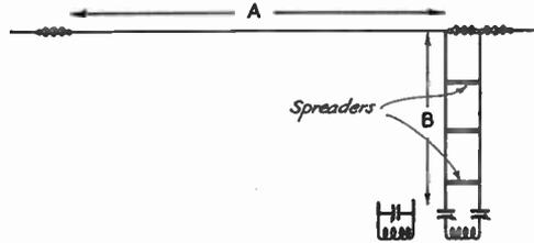
**FIG. 1607 — THE ZEPPELIN ANTENNA**
