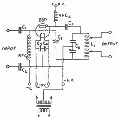
FIG. 922 — THE SINGLE-TUBE AMPLIFIER CIRCUIT DIAGRAM
