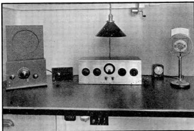
**THE OPERATING POSITION OF AN ULTRA-HIGH-FREQUENCY STATION**
