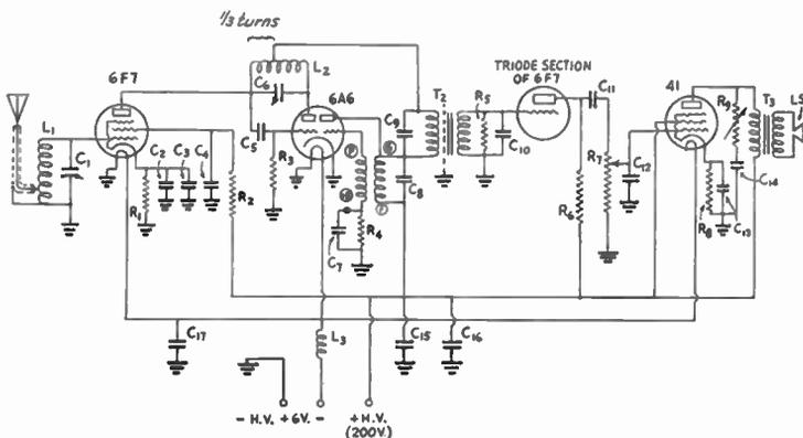
FIG. 1311 — CIRCUIT OF THE POLICE-TYPE SUPERREGENERATIVE RECEIVER
