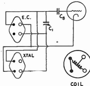
FIG. 933 — ALTERNATIVE OSCILLATOR GRID CIRCUIT CONNECTIONS FOR SELF-CONTROLLED OPERATION
