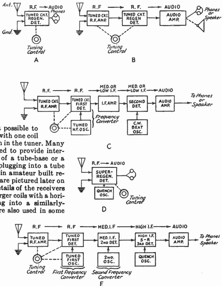
FIG. 601 — BLOCK DIAGRAMS SHOWING THE ESSENTIAL UNITS OF BASIC RECEIVER TYPES. A, SIMPLE REGENERATIVE; B, TUNED R.F. REGENERATIVE; C, SUPERHETERODYNE; D, SUPER-REGENERATIVE; E, SUPER-INFRA-REGENERATIVE. THE LAST TWO ARE ULTRA-HIGH FREQUENCY TYPES
