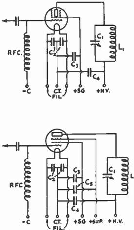
FIG. 822—TYPICAL SCREEN-GRID AMPLIFIER CIRCUITS
