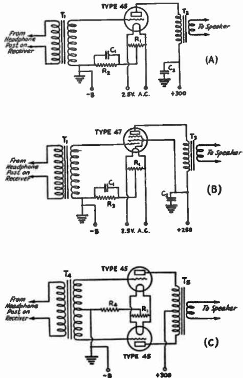
FIG. 606 — AUDIO POWER AMPLIFIERS FOR LOUD-SPEAKER OPERATION
