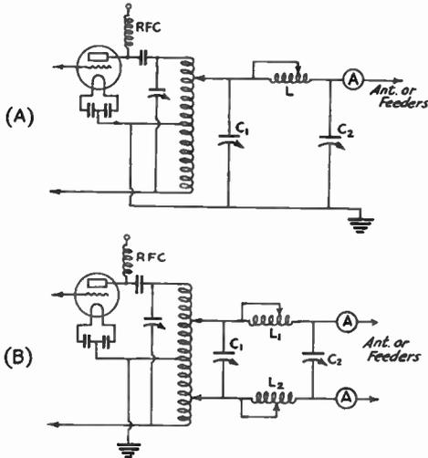
**FIG. 829 — ANTENNA-COUPLING FILTERS**
