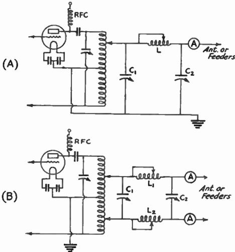
**FIG. 829 — ANTENNA-COUPLING FILTERS**
