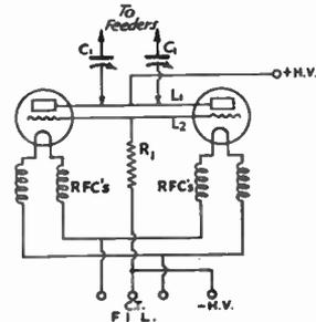
FIG. 1404—A PUSH-PULL VERSION OF THE LINEAR OSCILLATOR
