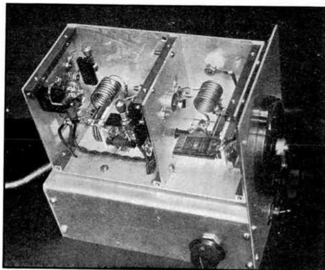
**FIG. 1315 — A SIDE VIEW OF THE RECEIVER SHOWING THE ARRANGEMENT INSIDE THE SHIELD BOX**
