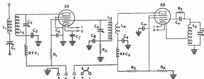
**FIG. 1417 — CIRCUIT DIAGRAM OF THE LOW-POWER OSCILLATOR-AMPLIFIER TRANSMITTER**
