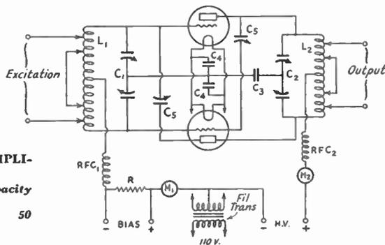
FIG. 925 — CIRCUIT OF THE PUSH-PULL AMPLIFIER
