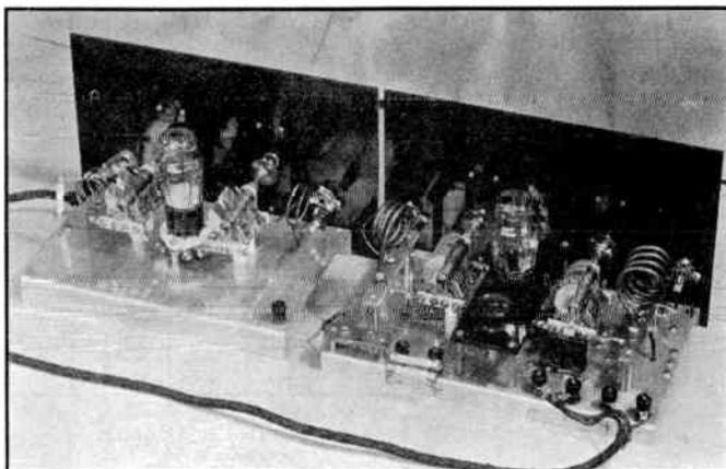
**FIG. 1418 — A REAR VIEW OF THE SIMPLE OSCILLATOR-AMPLIFIER TRANSMITTER USING TRIODES**
