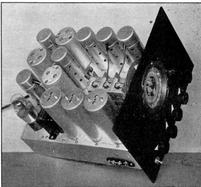
FIG. 726 — PANEL LAYOUT OF THE SEVEN-TUBE SUPERHET
