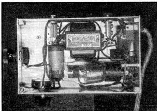
FIG. 1316 — THE UNDER SIDE OF THE PENTODE-ACORN RECEIVER
