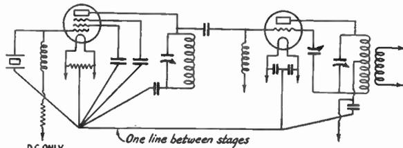
**FIG. 907 — GROUND LEADS FOR EACH STAGE SHOULD BE BROUGHT TO ONE POINT, WITH GROUND CONNECTIONS BETWEEN STAGES MADE AS SHOWN**
