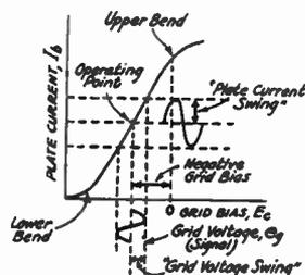
FIG. 502 — OPERATING CHARACTERISTICS OF A
