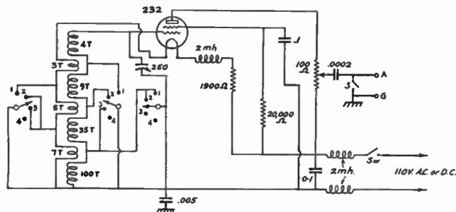
**FIG. 1713 — A WIDE RANGE TEST OSCILLATOR CIRCUIT**
