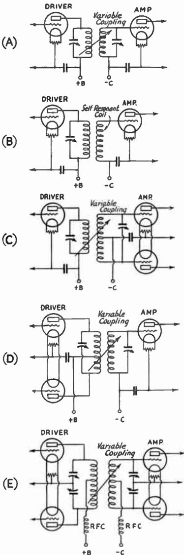
FIG. 815—INDUCTIVE INTERSTAGE COUPLING
