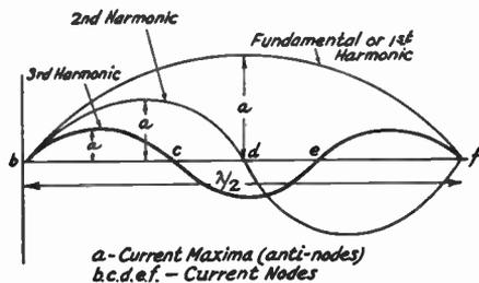
FIG. 412 — STANDING-WAVE CURRENT DISTRIBUTION ON AN ANTENNA OPERATING AS AN OSCILLATORY CIRCUIT AT ITS FUNDAMENTAL, SECOND HARMONIC AND THIRD HARMONIC FREQUENCIES
