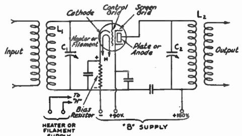
FIG. 515 — A TUNED RADIO-FREQUENCY AMPLIFIER CIRCUIT USING A SCREEN-GRID TETRODE
