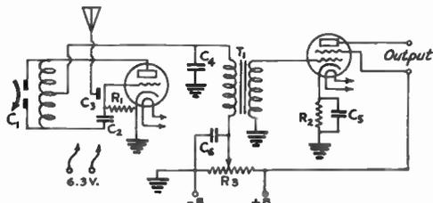
FIG. 1303 — CIRCUIT OF THE SIMPLE THREE-BAND RECEIVER
