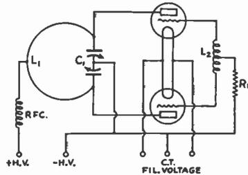
**FIG. 1401 — A SIMPLE 56-MC. OSCILLATOR CIRCUIT**
