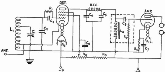
FIG. 704 — CIRCUIT DIAGRAM OF THE TWO-TUBE RECEIVER
