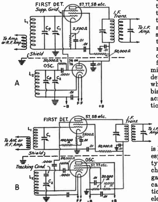
FIG. 610—CONVERTER CIRCUITS EMPLOYING SUPPRESSOR-GRID INJECTION
