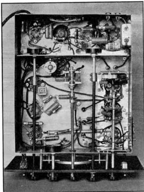
FIG. 727 — BOTTOM VIEW OF THE BAND-SWITCHING SUPERHETERODYNE
