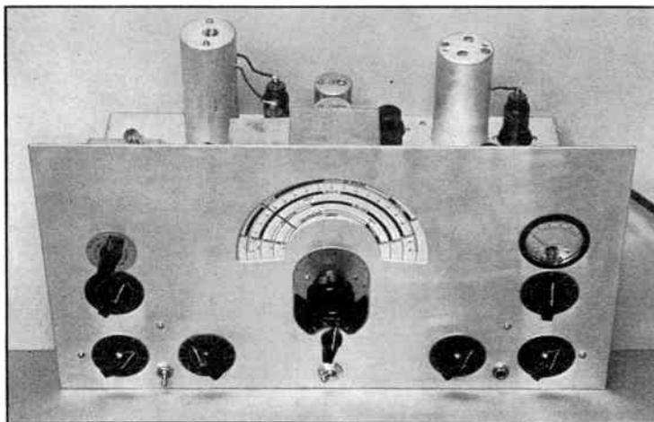
FIG. 701—A TWELVE-TUBE SINGLE-SIGNAL SUPERHETERODYNE RECEIVER OF ADVANCED DESIGN
