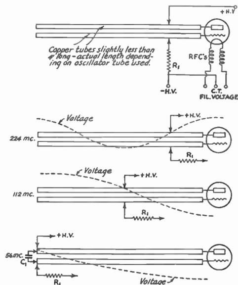
**FIG. 1405 — A THREE-BAND ULTRA-HIGH-FREQUENCY TRANSMITTER**
