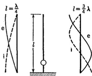
FIG. 8 C. A Marconi type antenna.
