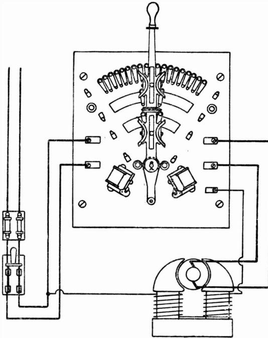
Fig. 29. Full Reverse Motor Starter.
