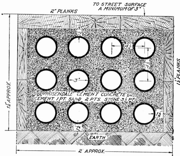
Fig. 46. Cross-Section of Wrought-Iron Pipe Conduit
