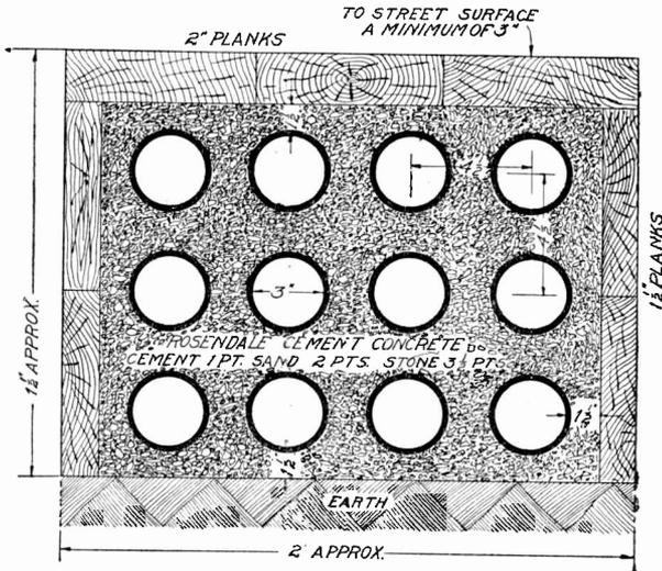
Fig. 46. Cross-Section of Wrought-Iron Pipe Conduit
