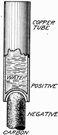
Fig. 15. Telefunken Electrodes
