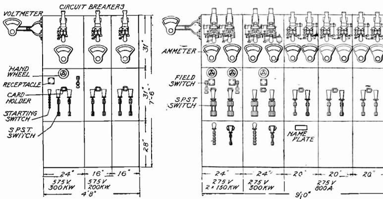
Fig. 24. Standard Switchboard Panel
