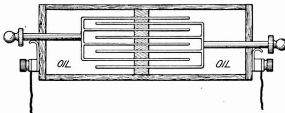
Fig. 30. Adjustable Condenser
