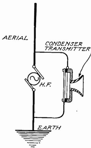
Fig. 12. Condenser Transmitter
