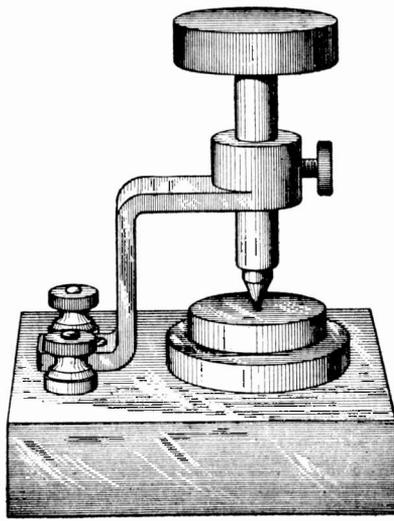
Fig. 45. Silicon Detector
