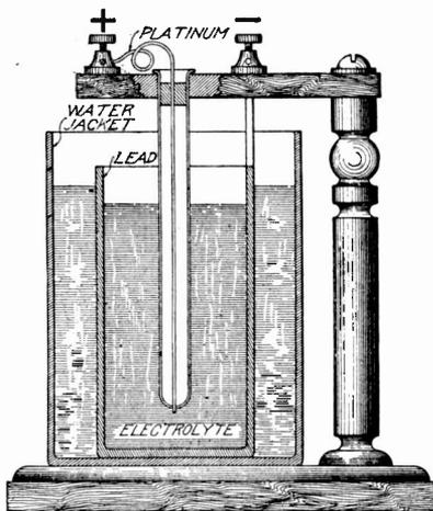
Fig. 27. Wehnelt Interrupter
