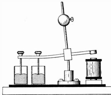
Fig. 25. Foucault Mercury Break
