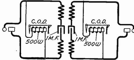
Fig. 136. Double Clearing-Out Drops
