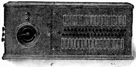
Fig. 245. Cummings-Wray Dispatcher's Sender
