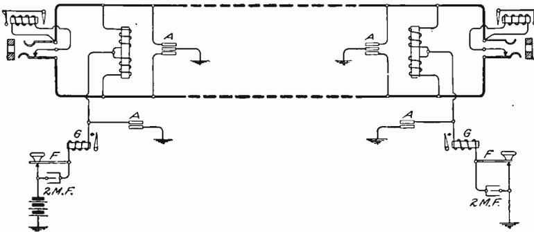
Fig. 231: Simplex Telegraph Circuit
