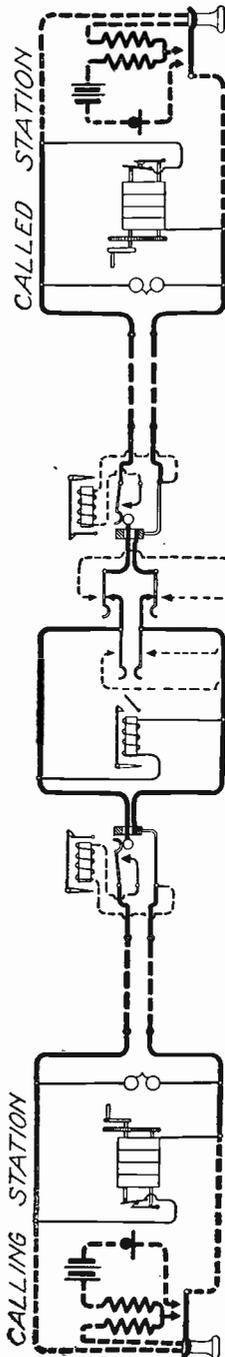
Fig. 93. Clearing-Out Signal
