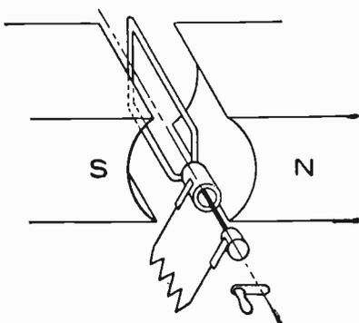
Fig. 24. Simple Dynamo Diagram
