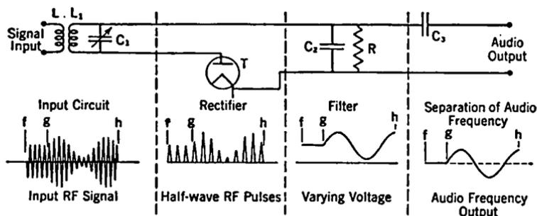
FIG. 11-27. Diode Detector.
