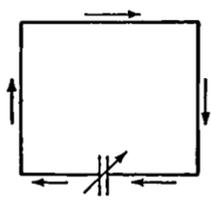
FIG. 16-24. Loop Antenna.
