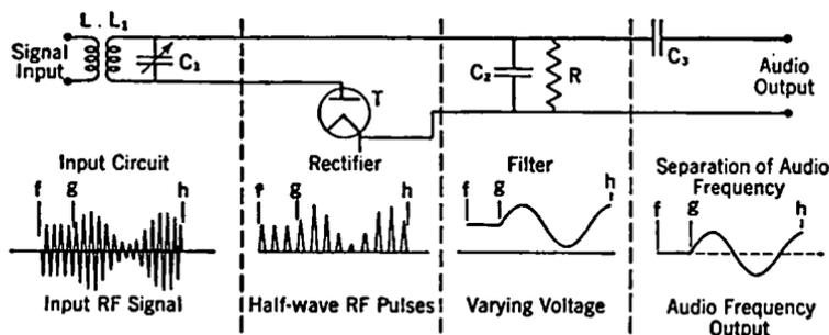
FIG. 11-27. Diode Detector.
