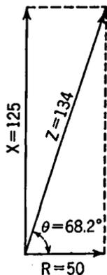
FIG 3-18. Impedance Diagram.
