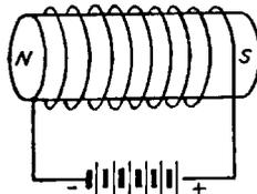
Fig. 11. An Electromagnet
