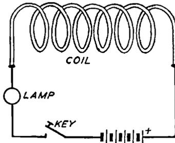
Fig. 22. An Electromagnet
