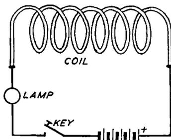
Fig. 22. An Electromagnet
