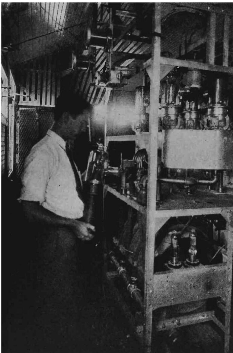
**A POWER AMPLIFIER IN A SHORT-WAVE RADIO TRANSMITTING STATION**
