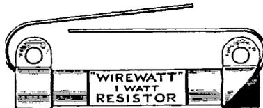
Fig. 27. A Wire-Wound Resistor
