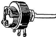
Fig. 28. Wire-Wound Rheostat and Potentiometer
