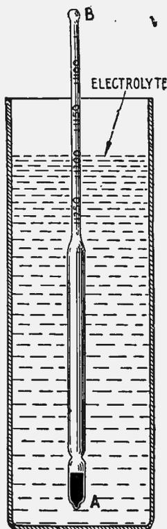
Fig. 80—The Hydrometer.
