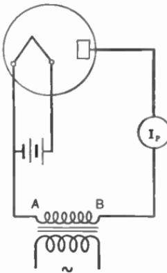
FIG. 237.—Fundamental rectifier circuit.
