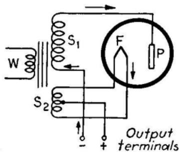
FIG. 286.—Simple rectifier circuit.
