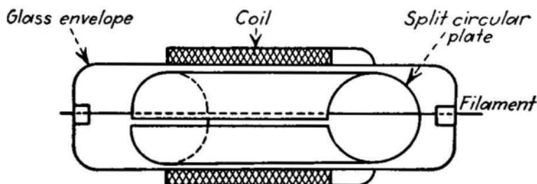
FIG. 188.—Diagram of magnetron.
