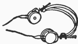
FIG. 19.—THE HEAD TELEPHONES OR RECEIVERS.
