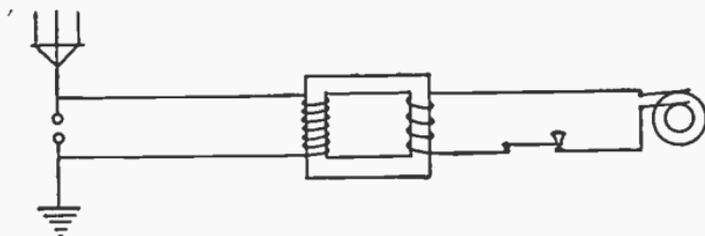
FIG. 96—ELEMENTS OF A SPARK TRANSMITTER.
