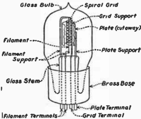
FIG. 47.—THE THREE ELEMENT VACUUM TUBE.
