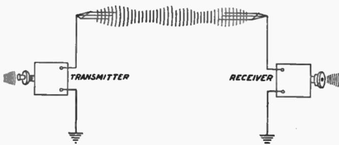
FIG. 1.—ELEMENTS OF A RADIO TELEPHONE SYSTEM.
