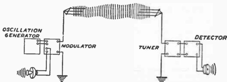
FIG. 53.—ESSENTIAL UNITS OF A RADIO TELEPHONE SYSTEM.
