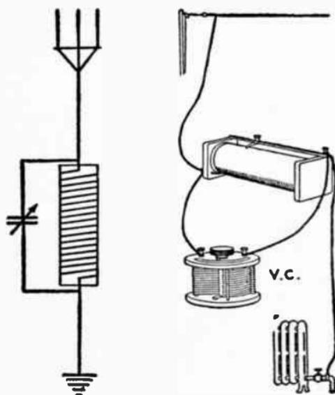
FIG. 25.—VARIABLE CONDENSER IN PARALLEL WITH THE AERIAL CIRCUIT TO INCREASE THE WAVE LENGTH OF THE CIRCUIT.
