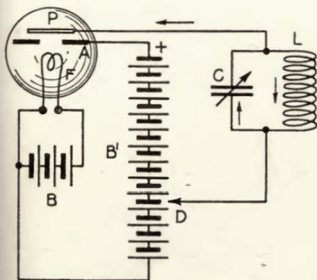
FIGURE 98—Dynatron oscillator.
