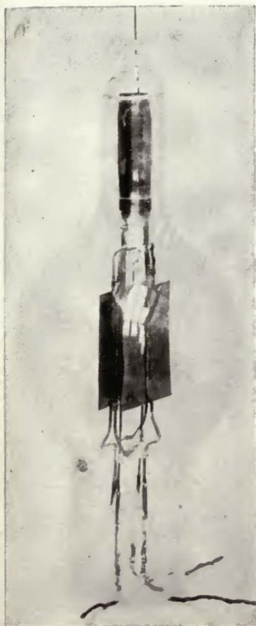
FIGURE 92—General Electric Company pilotron.
