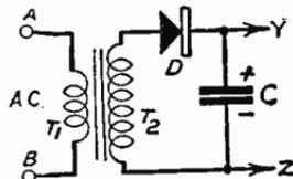
Fig. 315—Simplest metal rectifier system
