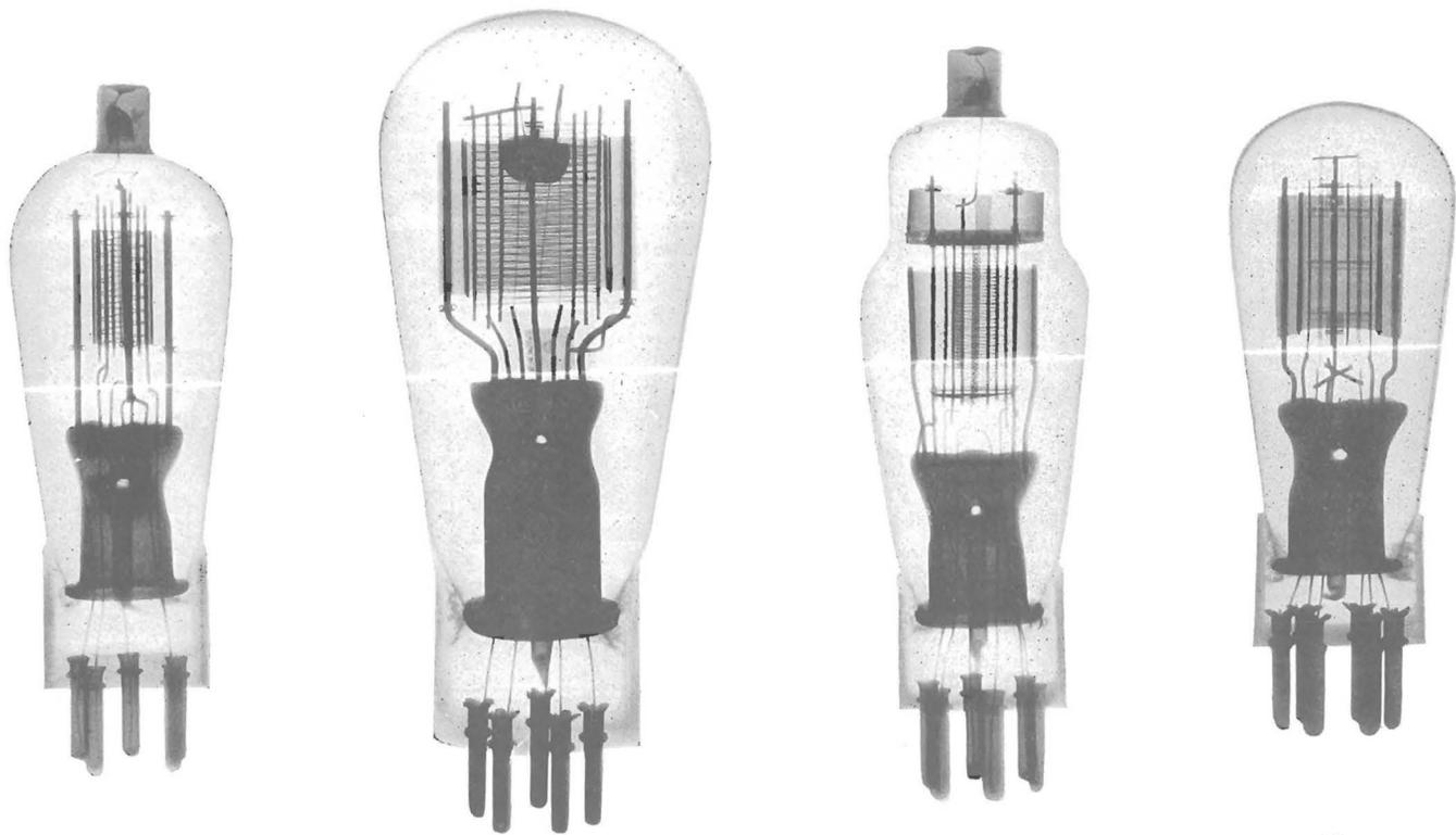
(a) Pentode, type 38; (b) pentode, type 47; (c) pentode, type 57; (d) double-cathode tube, type 29.
