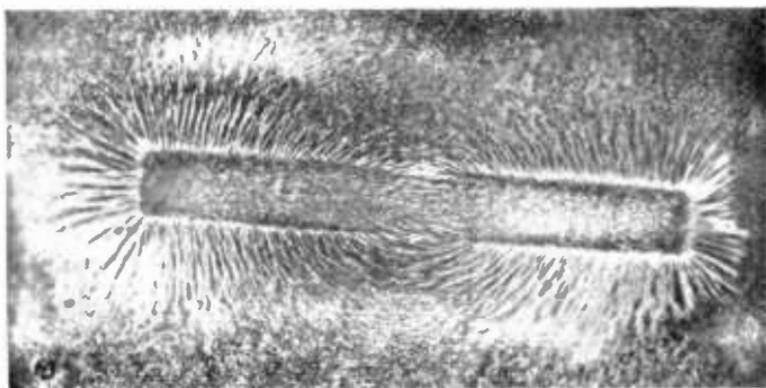
THE MAGNETIC FIELD AROUND A BAR MAGNET
