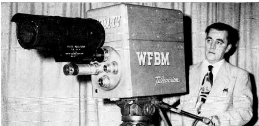
Fig. 5-4. Video Reflectar lens in use.
