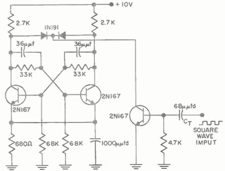
COLLECTOR TRIGGERING WITH TRIGGER AMPLIFIER
