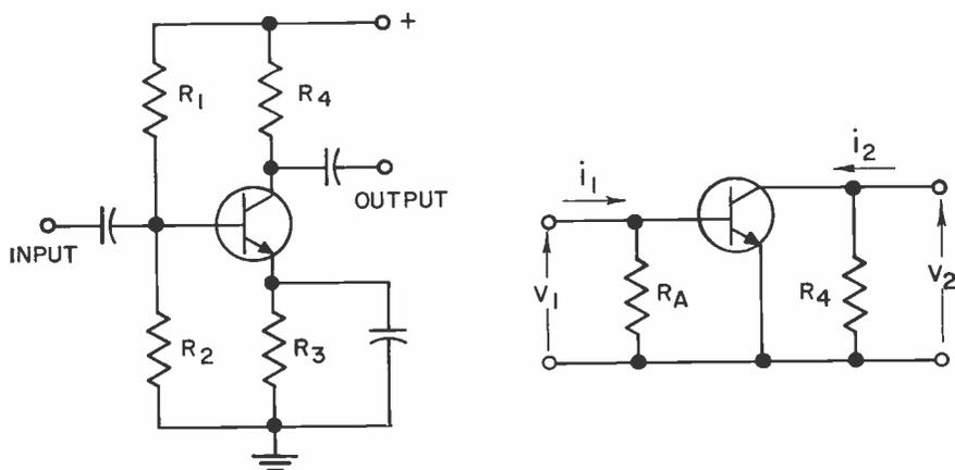
**TYPICAL LOW LEVEL A-C AMPLIFIER CIRCUIT AND A-C EQUIVALENT CIRCUIT**
