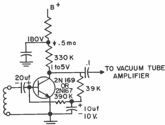
**NPN PREAMPLIFIER FOR MAGNETIC PICKUPS**
