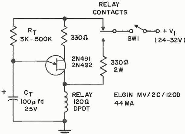
TIME DELAY CIRCUIT WITH RELAY
