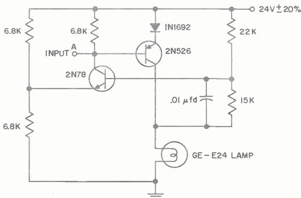
TRIGGER PULSE REQUIREMENT 2 VOLTS MAXIMUM.
