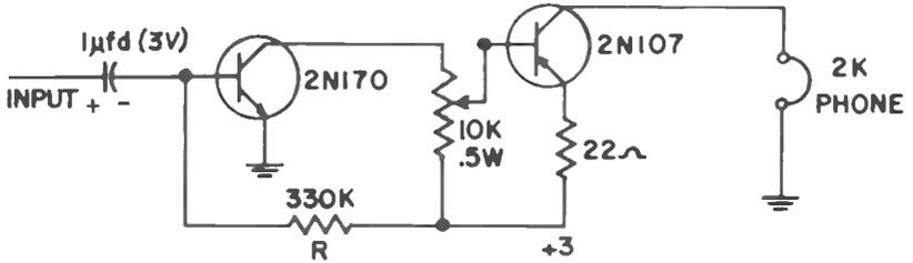
R SHOULD BE ADJUSTED FOR OPTIMUM RESULTS
