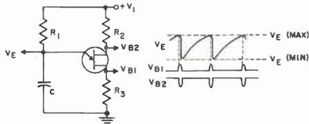
**BASIC RELAXATION OSCILLATOR WITH TYPICAL WAVEFORMS**
