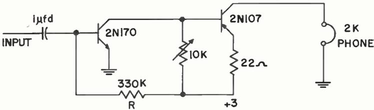
R SHOULD BE ADJUSTED FOR OPTIMUM RESULTS
