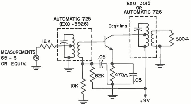
TYPICAL I F TEST CIRCUIT
