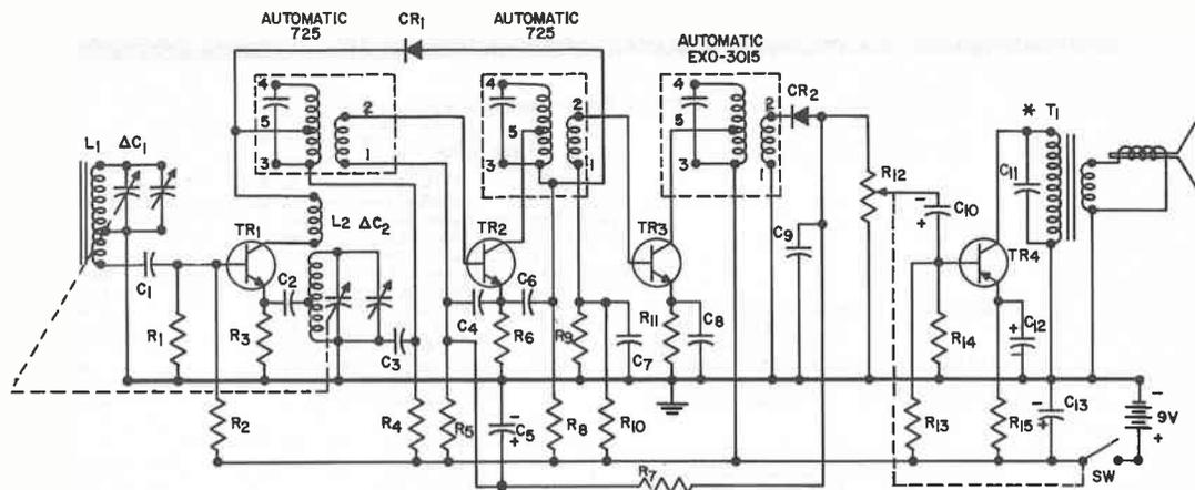
$R_1, R_7, R_9$ —10,000 OHM
