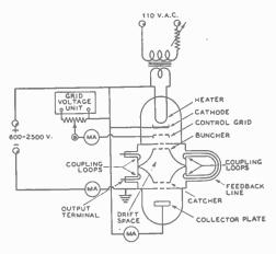
Figure 26. KLYSTRON OSCILLATOR.
