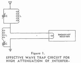
ING SIGNAL REACHING RECEIVER VIA ANTENNA.
