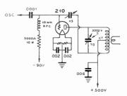
DRIVER FOR PUSH-PULL C TYPE 800 TUBES CLASS C
