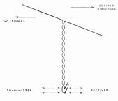
Figure 88—Tilt Doublet Antenna.
