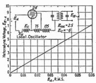
Fig. 21a.—I-f output versus r-f input.
