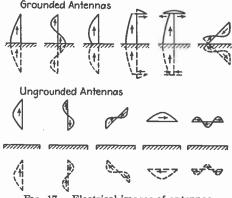
Fig. 17.—Electrical images of antennas.
