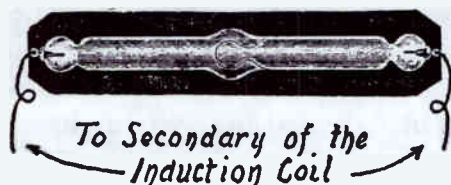
FIG. 89—A Geissler Tube.
