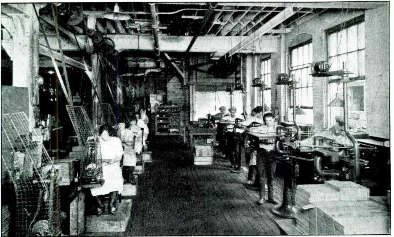
ENGRAVING AND FINISHING PANELS FOR FOUR-TUBE RECEIVERS
