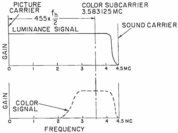
Fig. 4a - Composite signal.
