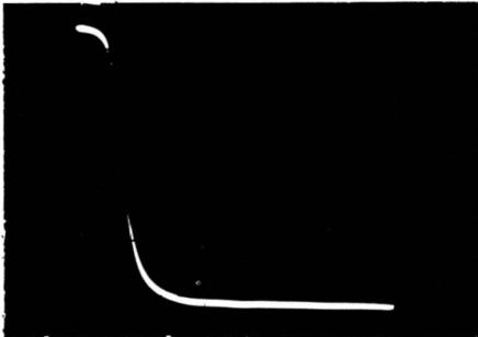
**Severe amplitude distortion (overload).**
