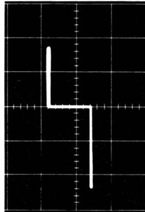
(D) Waveform of a 15-volt zener diode.
