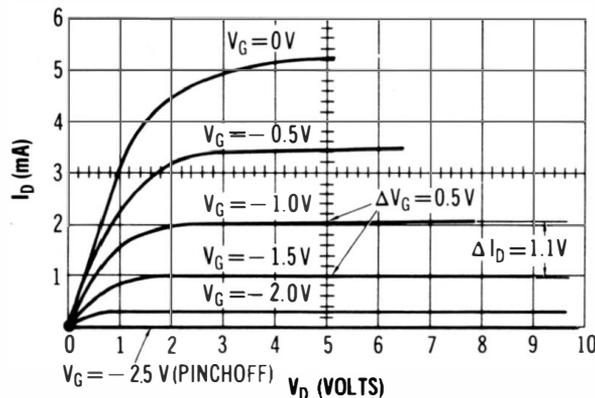
(PINCHOFF DENOTES ZERO DRAIN CURRENT; THE PINCHOFF VOLTAGE IS THE GATE VOLTAGE REQUIRED TO BRING THE DRAIN CURRENT TO ZERO)
