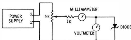
Fig. 1-16. Test setup for a zener diode.
