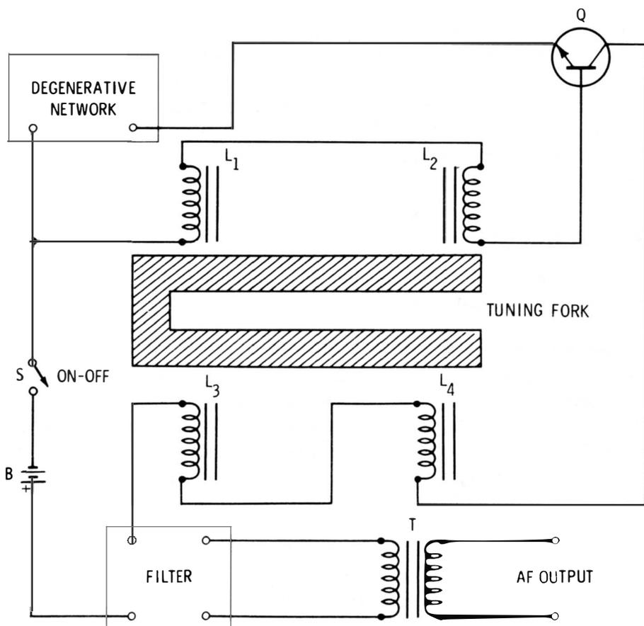
Fig. 4-6. Tuning-fork oscillator.
