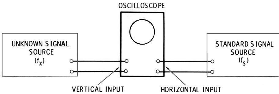
**Fig. 2-7. Test setup for Lissajous figures.**
