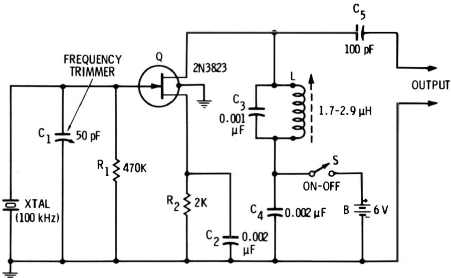
Fig. 4-3. 100-kHz crystal oscillator.
