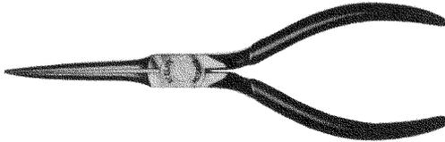
**Fig. 2-3. Long-nose pliers.**
