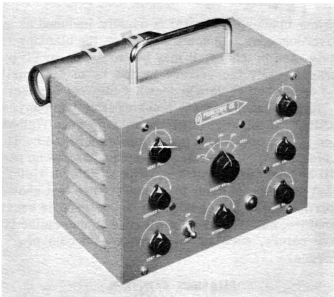
**Fig. 6-6. Probescope Model PO-1 oscilloscope.**
