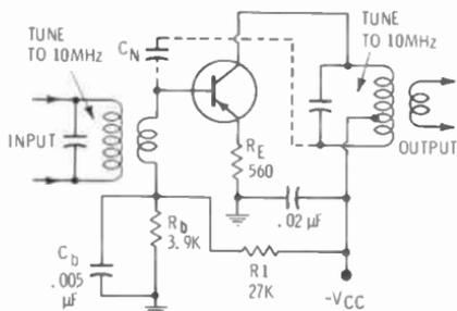
Fig. 8-27. Common-emitter rf amplifier.
