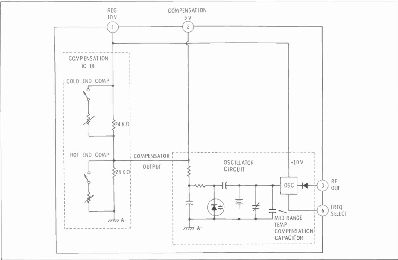
Fig. 4-9. Crystal oscillator module.
