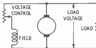
Fig. 9-9. Shunt dc generator.
