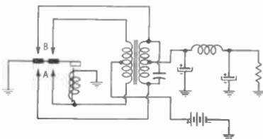
Fig. 9-6. Synchronous-vibrator circuit.
