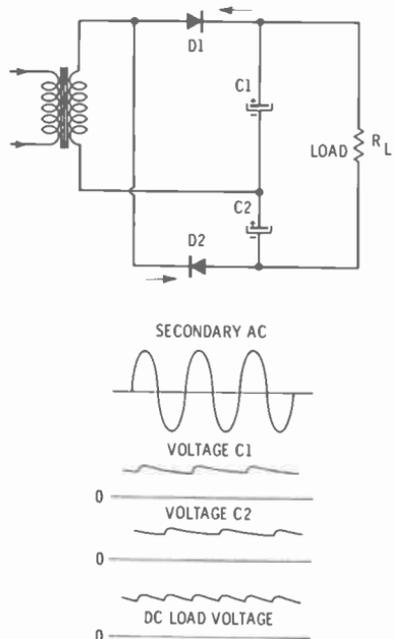
Fig. 9-4. Silicon rectifier voltage-doubler circuit.
