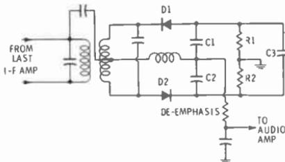
Fig. 12-12. Ratio detector.
