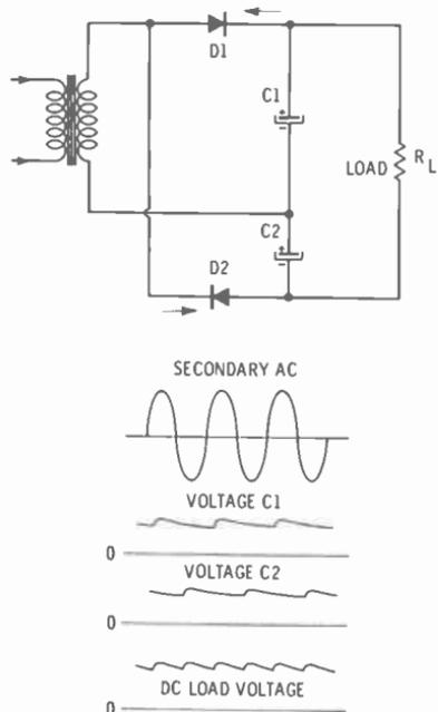
Fig. 9-4. Silicon rectifier voltage-doubler circuit.
