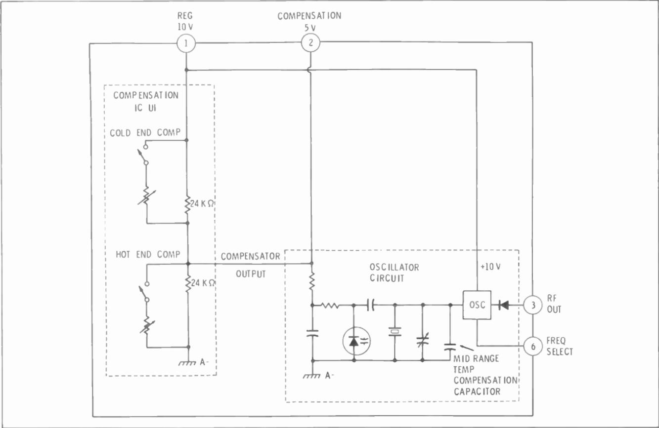
Fig. 4-9. Crystal oscillator module.
