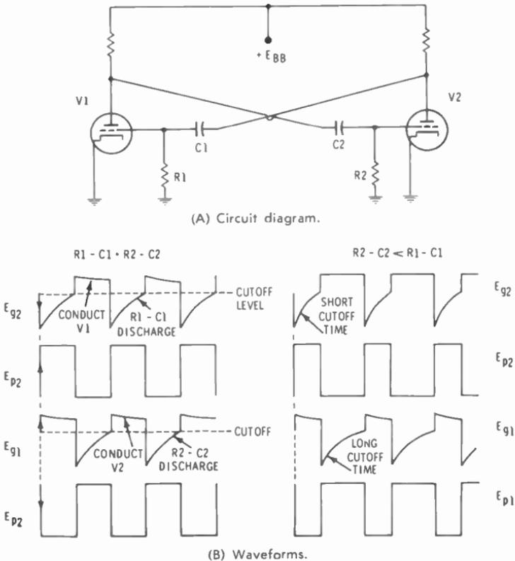
Fig. 10-28. Multivibrator circuit.
