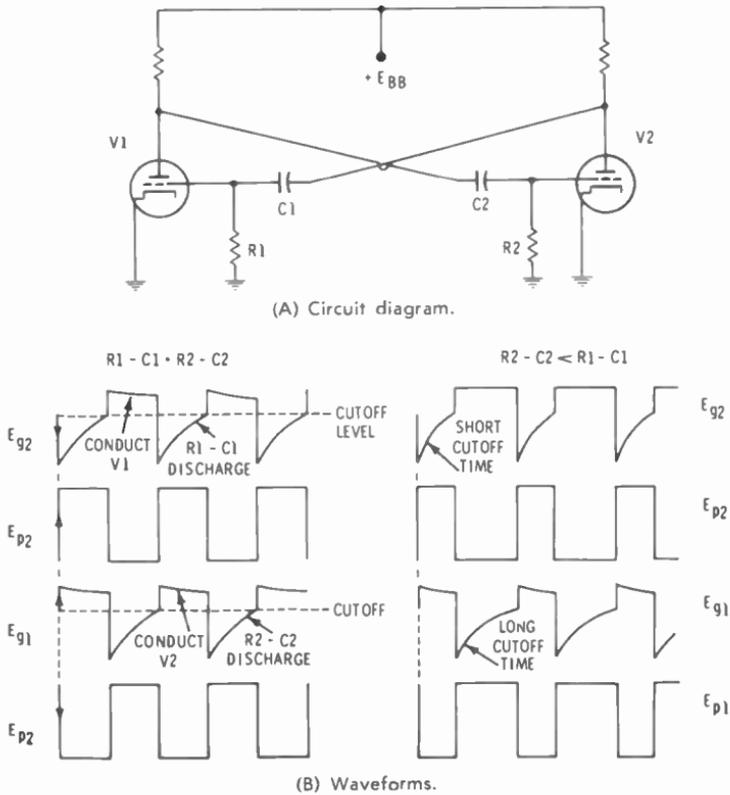
Fig. 10-28. Multivibrator circuit.
