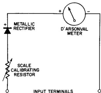
**Fig. 12-2. Rectifier Type AC Voltmeter.**
