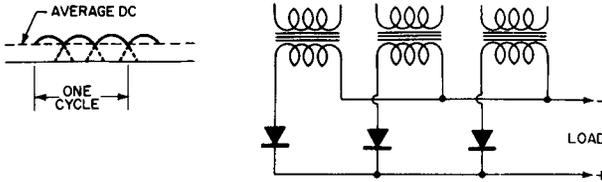
**Fig. 15-9. Three-Phase, Half-Wave Rectifier Circuit.**
