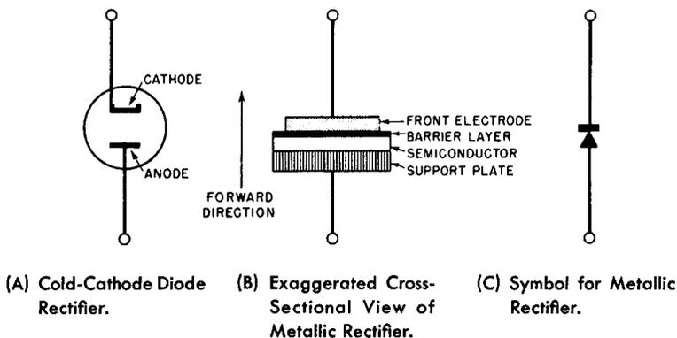
**Fig. 2-4. Comparison of Metallic Rectifier Cell to Cold-Cathode Rectifier.**
