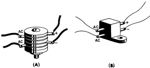
**Fig. 12-4. Instrument Rectifiers.**
