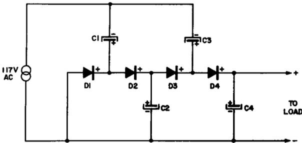
**Fig. 9-17. A Voltage-Quadrupler Rectification Circuit.**
