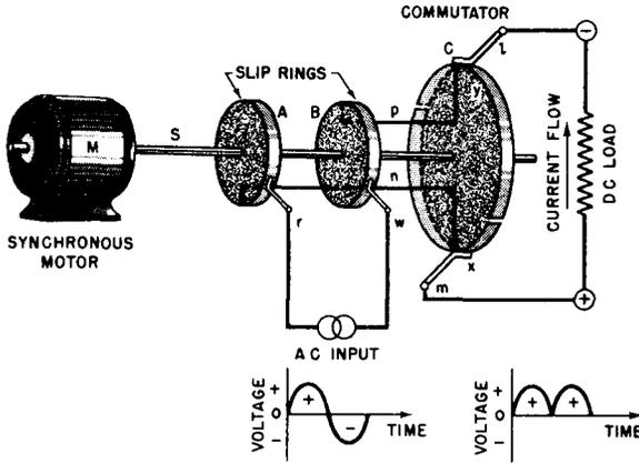
**Fig. 1-1. A Mechanical Rectifier (Full Wave).**
