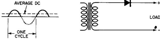
**Fig. 15-7. Single-Phase, Half-Wave Rectifier Circuit.**
