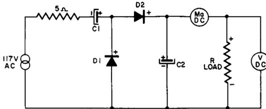
D1 & D2 SELENIUM HALF-WAVE RECTIFIERS AT 200Ma, 130V RMS.
