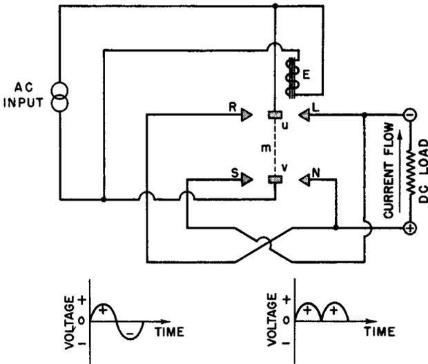
Fig. 1-2. A Vibrating Reed Rectifier (Full Wave).
