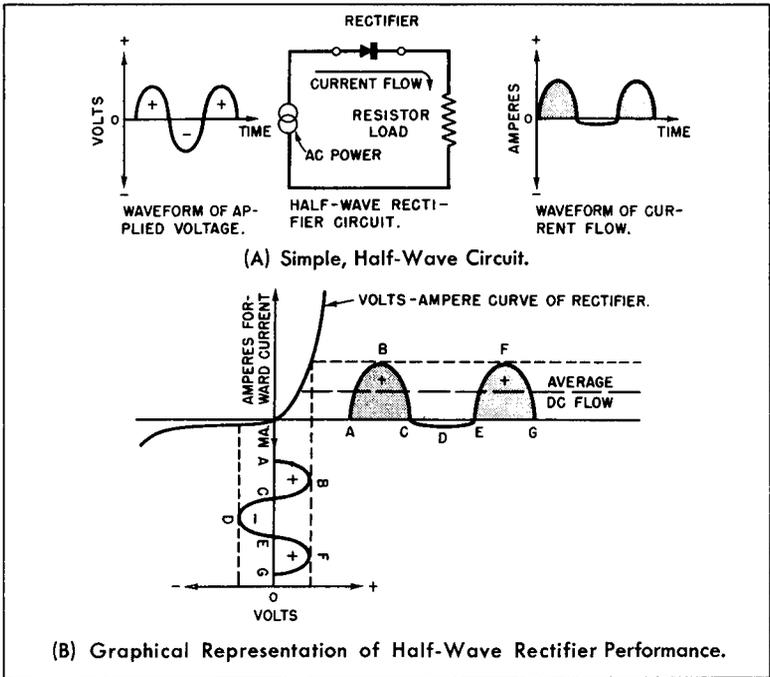
**Fig. 3-7. A Half-Wave Rectifier.**
