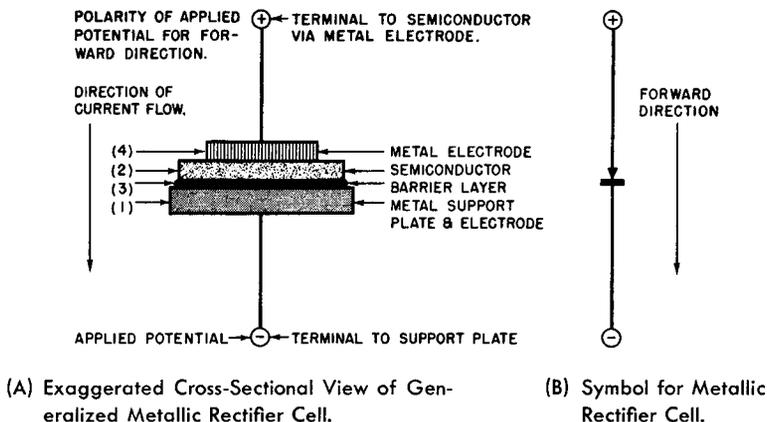
**Fig. 4-6. Generalized Metallic Rectifier Cell**
