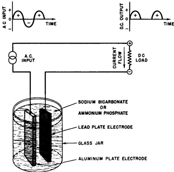
**Fig. 1-3. An Electrolytic Rectifier (Half Wave).**
