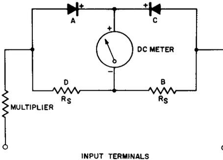
**Fig. 12-10. A Full-Wave Rectifier-Type AC Voltmeter Using Two Rectifiers.**
