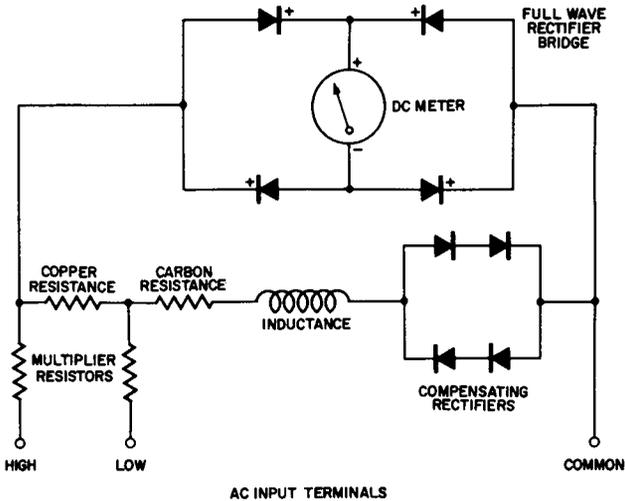
**Fig. 12-18. Compensated Rectifier-Type AC Voltmeter.**
