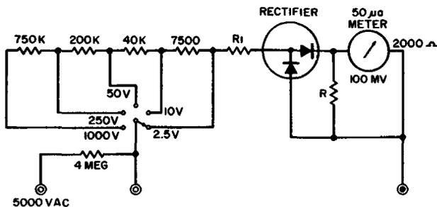
Fig. 1-9. AC-voltmeter configuration.
