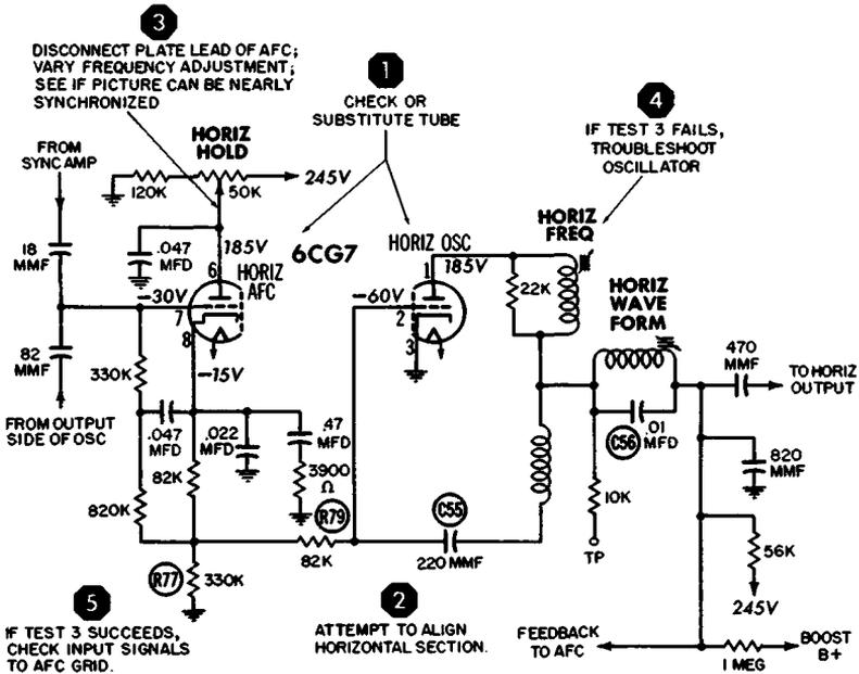
Fig. 4-6. The *Synchroguide* circuit.
