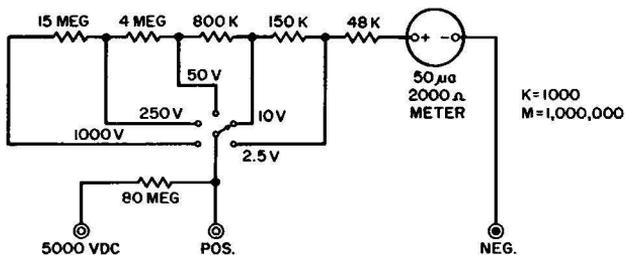
Fig. 1-8. DC-voltmeter configuration.
