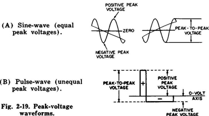
**Fig. 2-19. Peak-voltage waveforms.**
