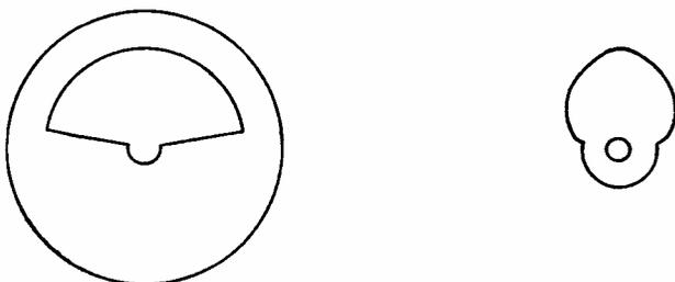
STATOR PLATE ROTOR PLATE
