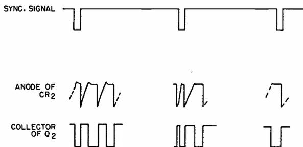
Fig. 2—Timing Waveforms
