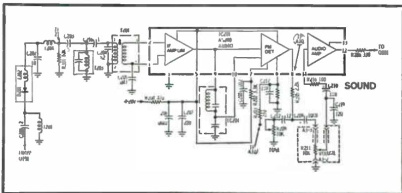
Fig. 3-66. IC IF/Limiter and detector circuit.
