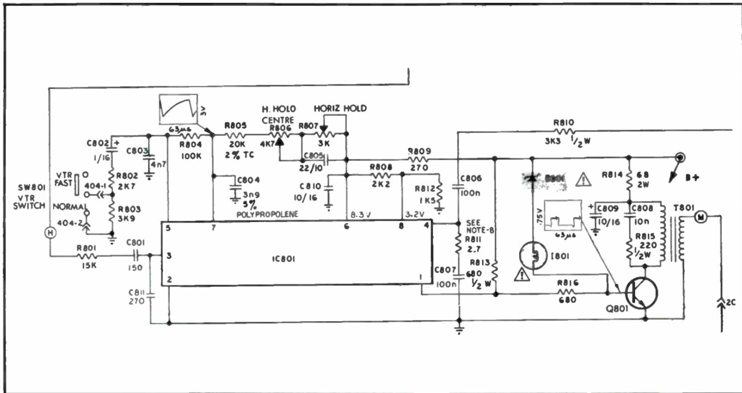
Fig.4-13. Horizontal oscillator - IC type.
