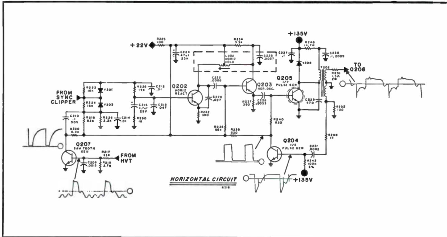
Fig. 6-14. Analog circuit.
