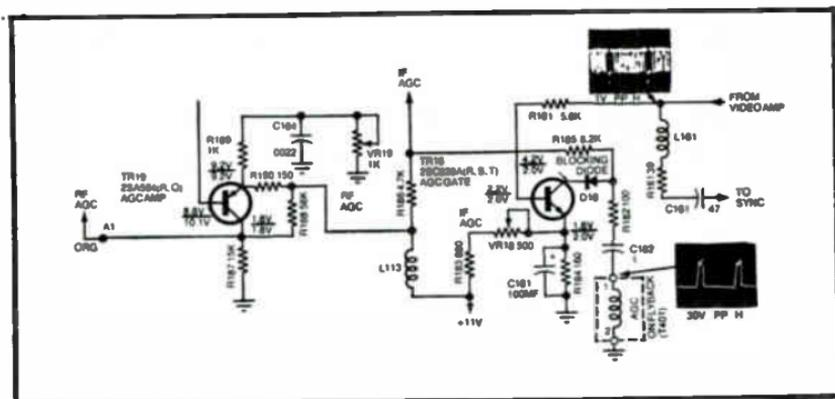
Fig. 4-7. RF AGC circuit.
