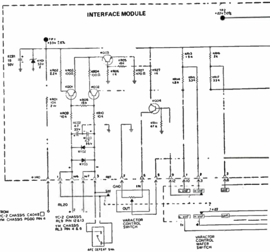
Fig. 1-14. Interface module diagram.
