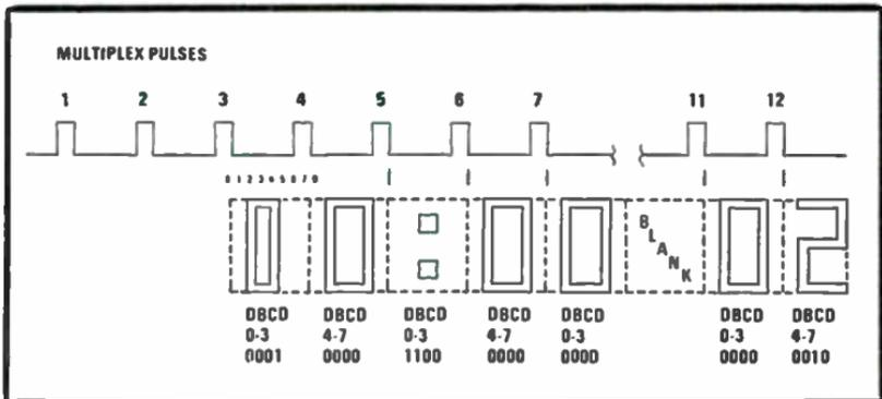
Fig. 9-7. Clock IC outputs.
