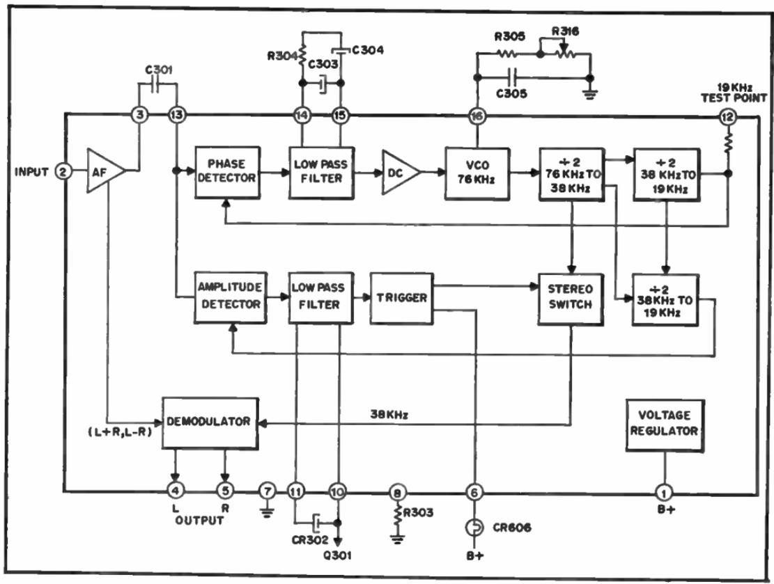
Fig. 5-9. Multiplex IC block diagram.
