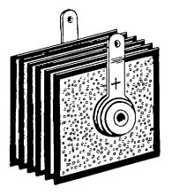
Fig. 28-6. The selenium rectifier.
