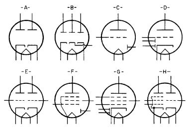
Fig. 27-18. Typical multiunit tubes
