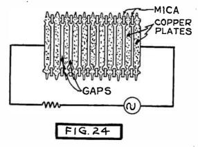
Fig. 24. Quenched Spark Gap.
