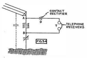
Fig. 34. Simple Crystal Detector.
