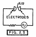
Fig. 23. Simple Spark Gap.
