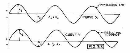
Fig. 33. Rectified Current.
