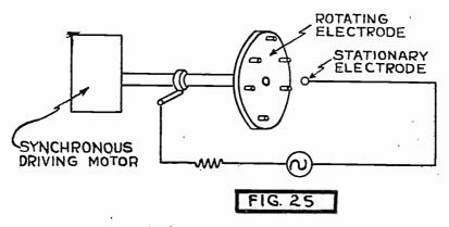
Fig. 25. Rotary Spark Gap,
