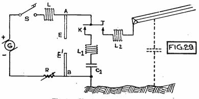
Fig. 29. Simple Arc Transmitter.
