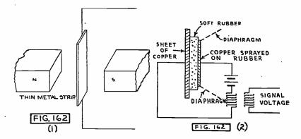
Fig. 162(1). Metal Strip Loud Speaker. Fig. 162(2). Electrostatic Speaker.
