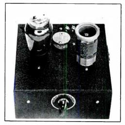
FIG. 835 — THE GRID-PLATE OSCILLATOR TRANSMITTER
