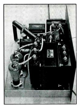
FIG. 1420 — HIGH-POWER POWER SUPPLY WITH 866 TUBES
