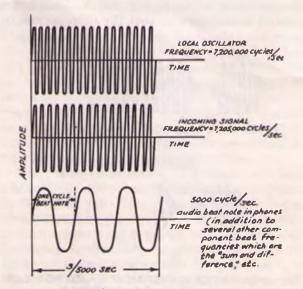
FIG. 419 -- ILLUSTRATING HETERODYNE ACTION
