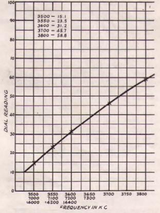
FIG. 610 - TYPICAL CALIBRATION CURVE FOR THE FREQUENCY METER
