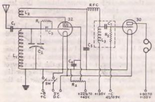
FIG. 514 - DIAGRAM OF TWO-TUBE RECEIVER FOR 2-VOLT D.C. OPERATION
