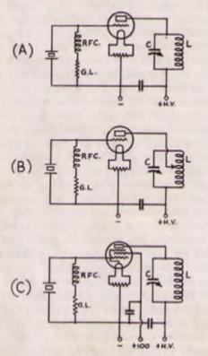
FIG. 713 - TYPICAL CRYSTAL OSCILLATOR CIRCUITS
