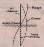
FIG. 1202 — THE SIMPLEST FORM OF GROUNDED ANTENNA
