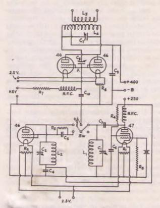
FIG. 721 — COMPLETE CIRCUIT DIAGRAM OF THE LOW-POWER CRYSTAL TRANSMITTER
