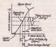
FIG. 405 — OPERATING CHARACTERISTICS OF A VAC-UUM TUBE AMPLIFIER
