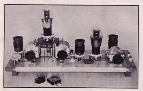
FIG. 722 - A BREADBOARD EXCITER UNIT
