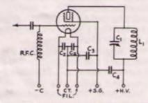
FIG. 719 - TYPICAL SCREEN-GRID AMPLIFIER CIRCUIT
