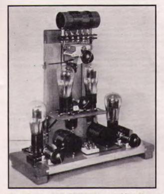
FIG. 720 — A LOW-POWER CRYSTAL-CONTROLLED TRANSMITTER FOR OPERATION IN THREE AMATEUR BANDS
