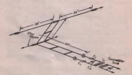
FIG. 1216 — A CURRENT-FEED SYSTEM FOR SEVERAL BANDS
