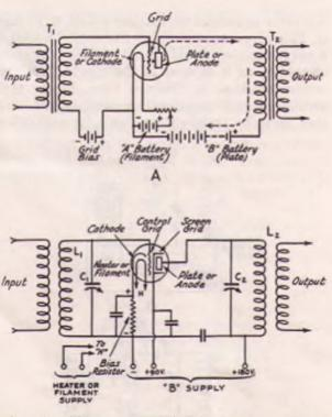
FIG. 406 --- CIRCUITS OF TYPICAL VACUUM TUBE AM-PLIFIERS
