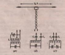
FIG. 1921 - A HALF-WAVE ANTENNA CENTER-FED BY A TWISTED PAIR LINE
