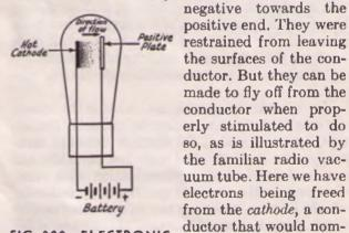
FIG. 302-ELECTRONIC CONDUCTION BY ELEC-TRON EMISSION IN THE VACUUM TUBE
