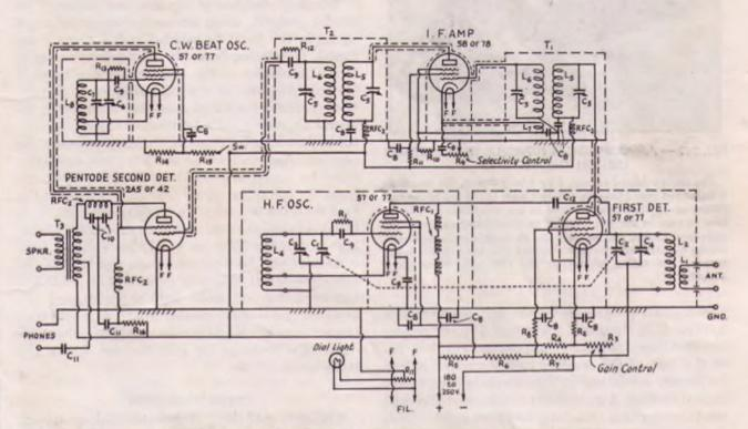
FIG. 522 - COMPLETE CIRCUIT OF THE FIVE-TUBE S. S. SUPERHET
