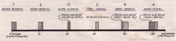
RELATIVE POSITION AND WIDTH OF THE AMATEUR BANDS IN THE HIGH-FRE-QUENCY SPECTRUM
