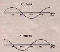
FIG. 1201 — STANDING WAVES ON AN OPEN-ENDED WIRE EXCITED BY HIGH-FREQUENCY ALTERNATING POWER
