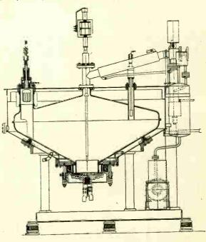
Cross Section of 1000-kw., 600-volt Rectifier
