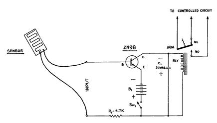
Fig. 10-4.—"Rain Alarm" circuit.
