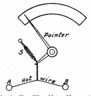
Fig. 7.-Hot Wire Meter Movement.
