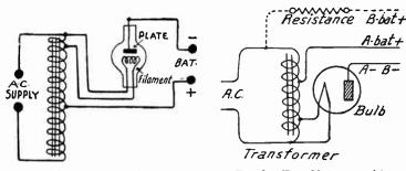
Fig. 2.—Auto-transformer for Rectifier.
