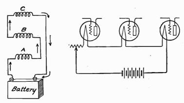
Fig. 1 .- A Series Circuit.
