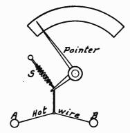
Fig. 6.—Thermocouple Meter.
