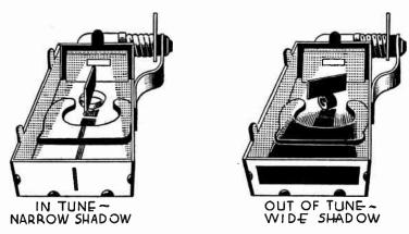
Fig. 12.—Iron Vane Tuning Meter
