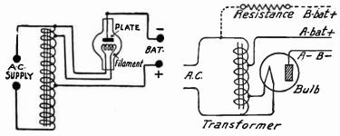
Fig. 2.—Auto-transformer for Rectifier.
