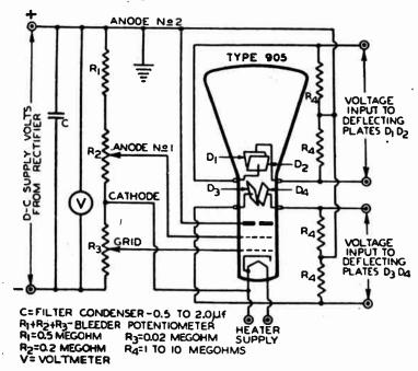
TYPICAL OSCILLOGRAPH CIRCUIT
