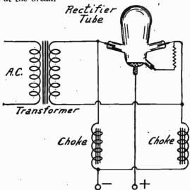
Circuits of Mercury Arc Rectifier.
