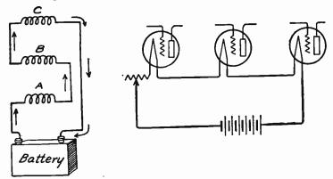
Fig. 1.-A Series Circuit.
