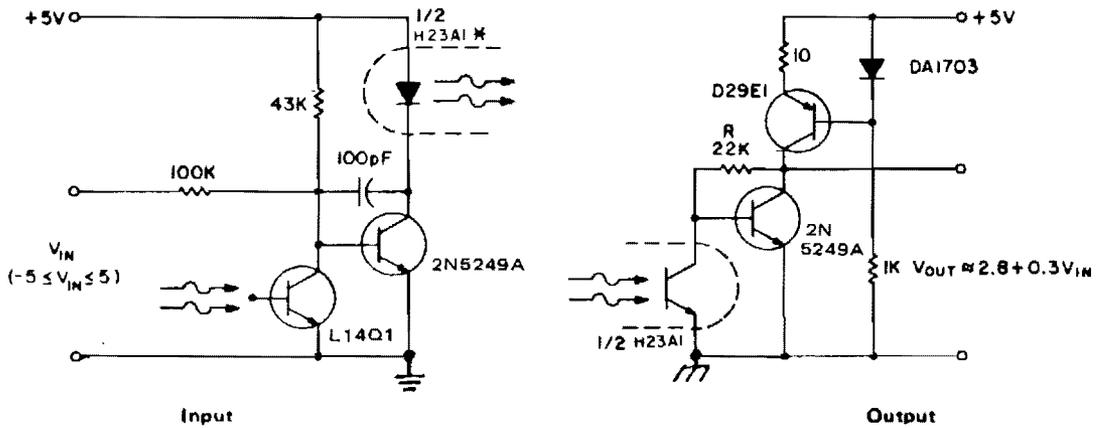
**LINEAR OPTICAL COUPLER CIRCUIT**
