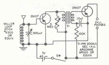
TWO TRANSISTOR RADIO RECEIVER
