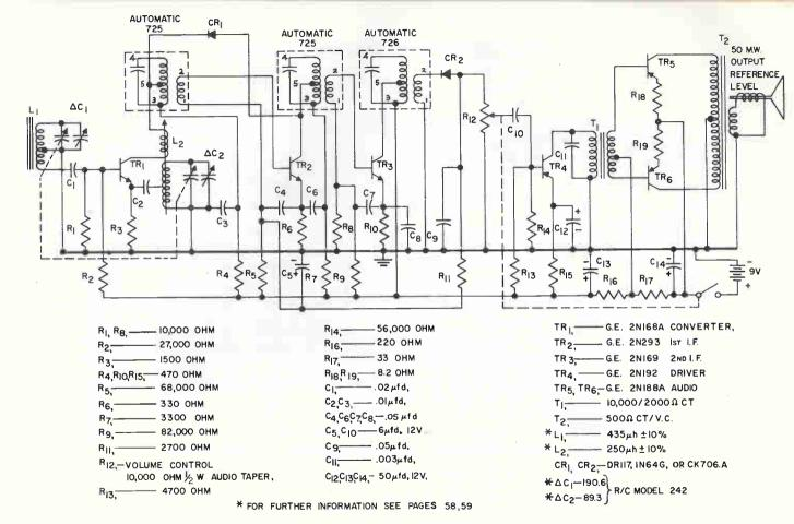
SIX TRANSISTOR SUPERHETERODYNE BROADCAST RECEIVER
