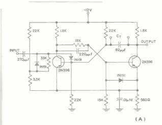
OUTPUT AT COLLECTORS HAS 8 VOLT LEVEL CHANGE OUTPUT PULSE DURATION 22SEC TO I SEC MAXIMUM INPUT FREQUENCY 25OKC MAXIMUM REQUIRED INPUT PULSE IS 5 VOLTS DUTY CYCLE EXCEEDS 60% AMBIENT TEMPERATURE -55°C TO 71°C
