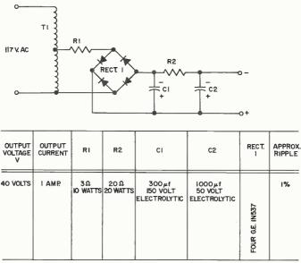
TI - U.T.C. R-43 AUTOTRANSFORMER OR EQUAL
