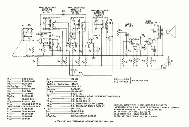
FIVE TRANSISTOR SUPERHETERODYNE BROADCAST RECEIVER
