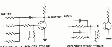
CLAMPING DIODE REDUCES STORAGE TIME TO INCREASE SPEED
