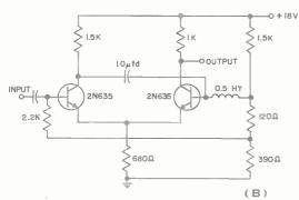
OUTPUT AT COLLECTOR HAS 5 VOLT LEVEL CHANGE OUTPUT PULSE DURATION APPROX 600 MICROSECONDS MAXIMUM INPUT PULSE REQUIRED 3 VOLTS AMBIENT TEMPERATURE - 55°C TO 71°C
