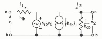
HYBRID EQUIVALENT CIRCUIT (COMMON BASE CONFIGURATION)
