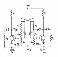
CIRCUIT CONFIGURATION FOR NON-SATURATING FLIP-FLOP DESIGN PROCEDURE
