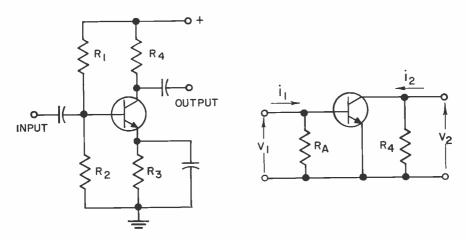
TYPICAL LOW LEVEL A-C AMPLIFIER CIRCUIT AND A-C EQUIVALENT CIRCUIT
