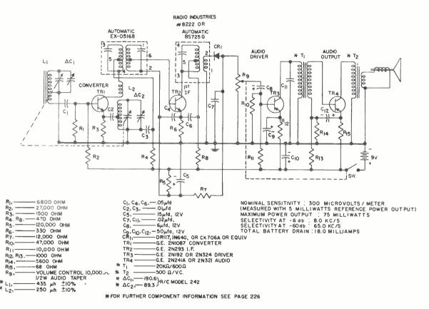
FOUR TRANSISTOR SUPERHETERODYNE BROADCAST RECEIVER
