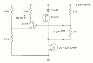
TRIGGER PULSE REQUIREMENT 2 VOLTS MAXIMUM. AMBIENT TEMPERATURE -55°C TO 71°C RESISTOR TOLERANCE ± 10 % AT END OF LIFE.
