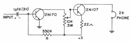
R SHOULD BE ADJUSTED FOR OPTIMUM RESULTS
